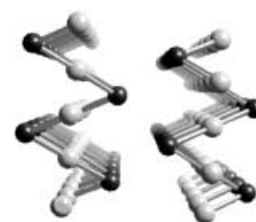
Abbildung 1. Festkörperstruktur von Gold(I)-iodid.
